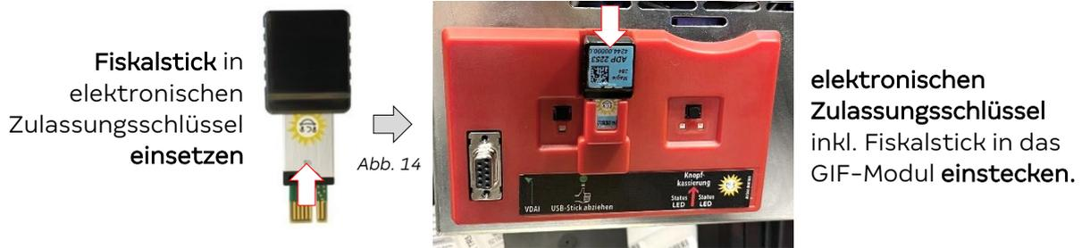
Dieser Arbeitsschritt ist nur bei Geldspielgeräten mit einem 2€ Hopper notwendig (z.B. bei einer M-Box, M-Box Max).
